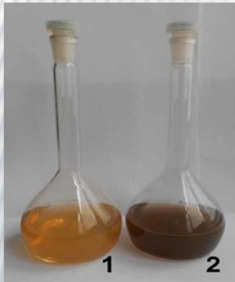
Fig. 1`. Soluție coloidală de Fe 3 O 4 15-20 nm (1), 60-70 nm (2), C=20mg/L
